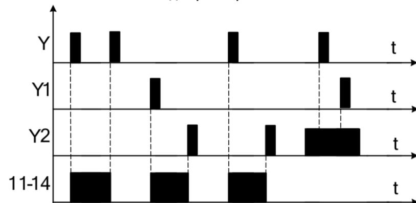
Местное управление импульсным реле
