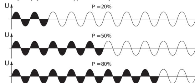
Мощность в нагрузке определяется числом периодов «N» во включенном состоянии за определенное количество периодов «T». При этом  $N = T * P / 100$ , где T-количество периодов, P - мощность в %.
