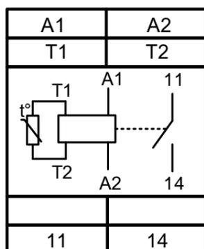
Схема включения термисторов
