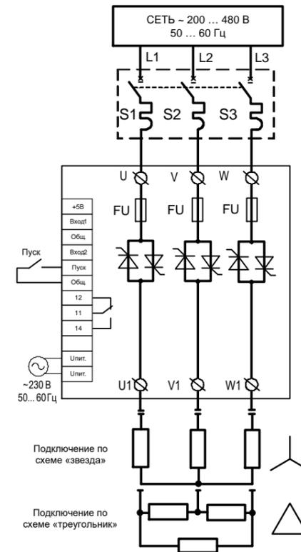
Схема подключения ТРМ-3МН
