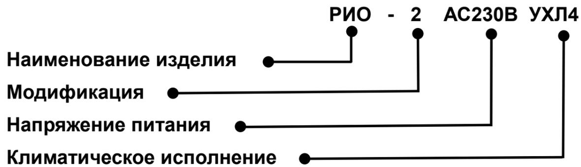
Импульсные реле освещения предназначены для дистанционного управления освещением в коридоре, на лестнице, этаже и т.п. с помощью параллельно соединённых кнопок с подсветкой. Дополнительные входы управления позволяют централизованно включать или выключать свет во всем доме, в зависимости от установленного режима работы организовывать различные схемы управления освещением.
