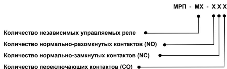
**МРП-М4-103 DC24В УХЛ4** (артикул EAN 2000016938104) — реле промежуточное с четырьмя независимыми управляемыми реле, где один замыкающий контакт и три переключающих контактах, в модульном корпусе шириной 22мм для установки на монтажную DIN рейку шириной 35мм. Максимальный ток контактной группы 3А, максимальный суммарный ток всех групп контактов 8А.
