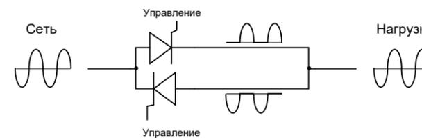
В режиме 50% мощности (тиристоры открыты на середине полупериода) работа тиристорного блока выглядит так (режим Phase Angle):
