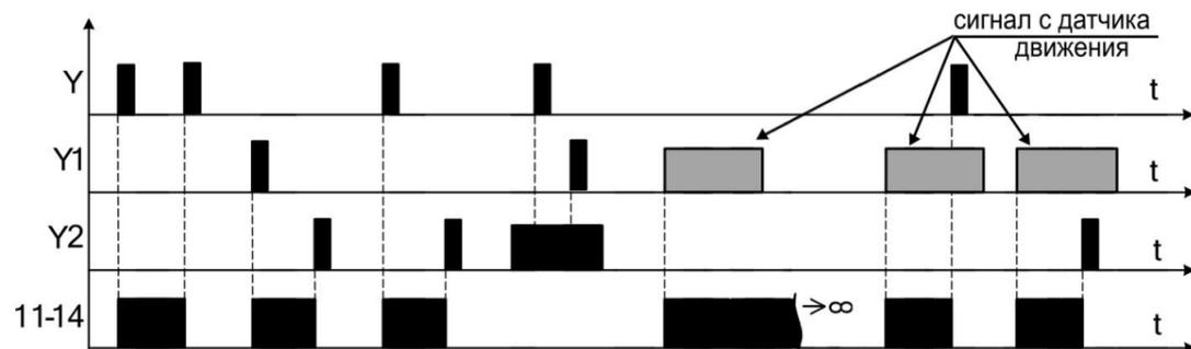
Местное управление импульсным реле
