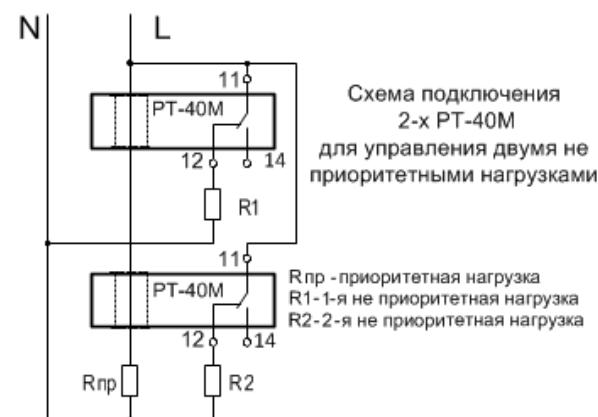
Схема подключения 2-х PT-40M
