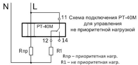
Схема подключения PT-40M
