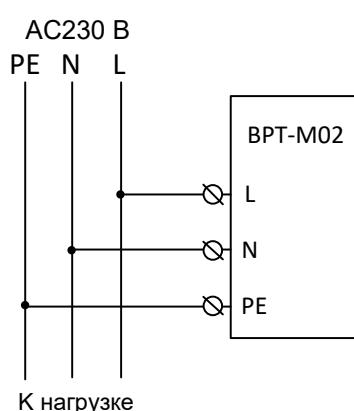
**Схема подключения для двухпроводной сети**
